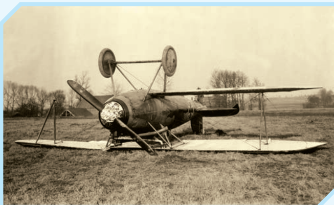
У этого Альбатроса D V летчика Ганса фон Хиппеля из Jasta 5 от перегрузок разрушилось крыло в бою 18 февраля 1918 г., и он выжил просто чудом, спланировав с высоты 1 500 м и скапотировав на посадке. Фото: http://www.jasta5.org/phpBB3...
