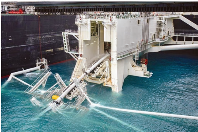
Рис. 5. Стингер в рабочем положении
