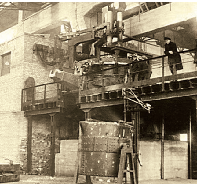
Рис. 7. Первая электросталеплавильная 10-тонная печь завода «Днепро-спецсталь» (производства фирмы «Демаг»), 1932 г.
