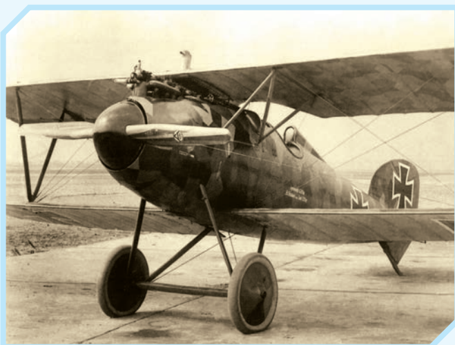
Первый опытный образец истребителя Альбатрос DV с новым фюзеляжем эллиптического сечения. Фото: http://forum.il2sturmovik.com/topic/13943-my-little-rof-ramble-wishes-impressions-airplanes-etc/
