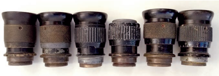
Окуляры биноклей Б-6 производства (слева направо): завод № 69 (1941 г.); завод № 353 (1942 г.); завод № 237 (1943 г.); завод № 355 (1943 г.); завод № 393 (1945 г.); завод № 393 (1946 г.). Как видим, окуляры отличаются не только материалом, из которого изготовлены, но и конструкцией, геометрическими размерами (у первых трех резьба для крепления в корпусе М 22 х 0,5, у остальных — М 23 х 0,75, также отличается количество витков и глубина посадки), что делает их не взаимозаменяемыми
