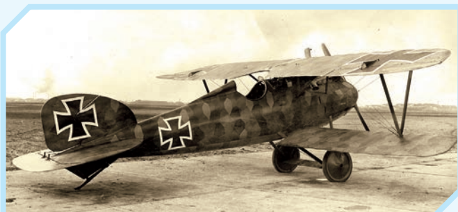
Самолет Альбатрос DV, в отличие от предшественника D III, не имел зализов на стыке нижнего крыла и фюзеляжа, что ухудшило обтекание этого места. Фото: http://imgbox.com/adsXHz85
