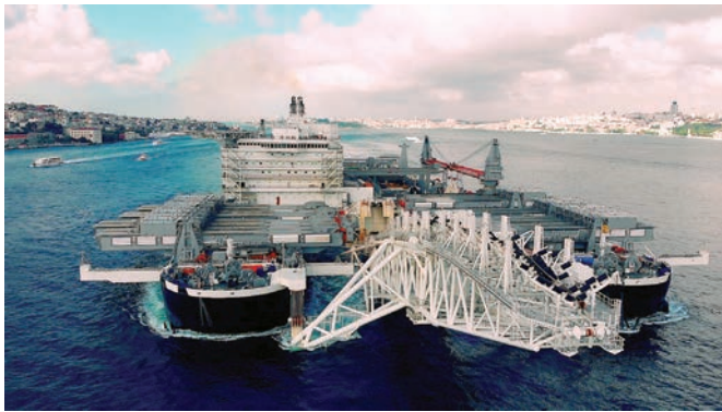
Рис. 4. Pioneer Spirit проходит Босфор с установленными стингером и балками для монтажа/демонтажа верхних строений
