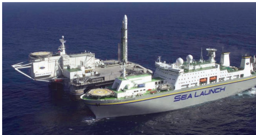
СКС и СП в точке старта, соединенные телескопическим мостом
