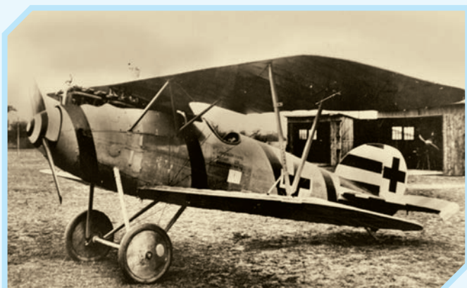
Для исключения поломок однолонжеронных нижних крыльев консольные стойки модифицированных Альбатросов D Va связали подкосами с передними кромками, но это не помогло. Фото: http://4.bp.blogspot.com/-zdWMLIOfriM/VdzjKMngdl...
