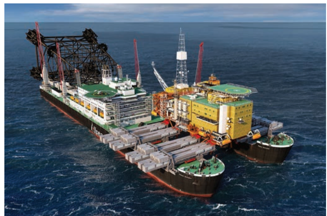
Рис. 11. Транспортировка верхнего строения и основания
