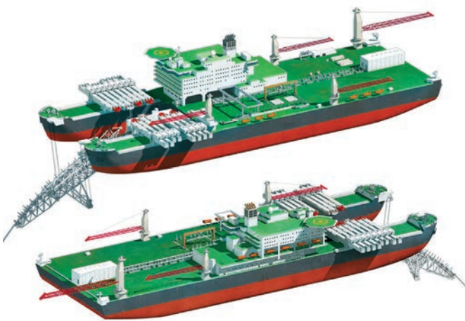
Рис. 4. Pioneer Spirit проходит Босфор с установленными стингером и балками для монтажа/демонтажа верхних строений
