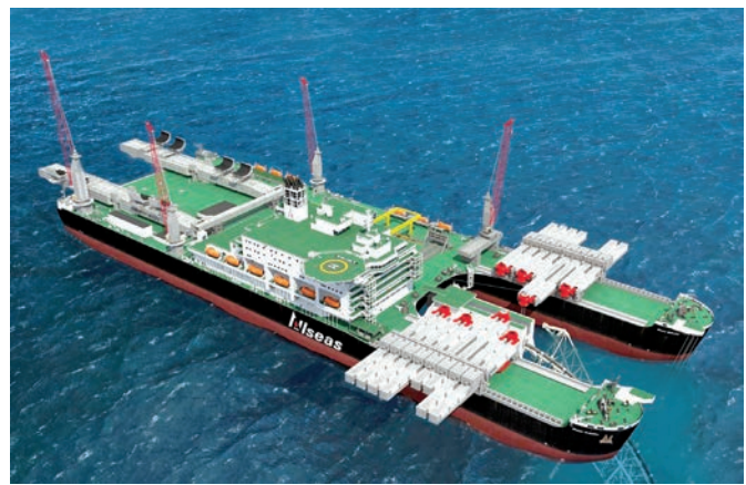
Рис. 9. Pioneer Spirit с установленными стингером, балками для операций с верхним строением и кормовым порталом для операций с основанием платформы
